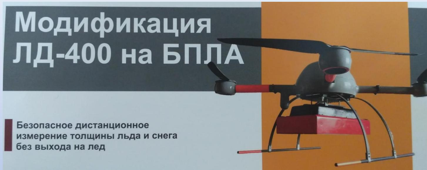
Ледомер ЛД-400. Измеряемая толщина льда и снега в режиме зависания на высоте 5-10 м. – не менее 2 м. Частота антенны 400 МГц.
