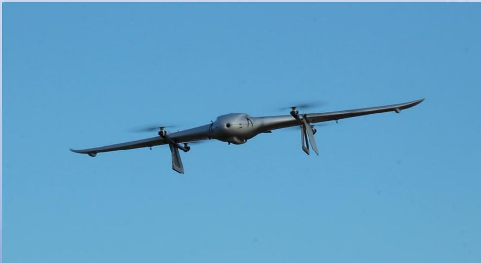
«ДИАМ 6» способен выполнить взлет и посадку в полностью автоматическом режиме с выходом на заданную точку.
